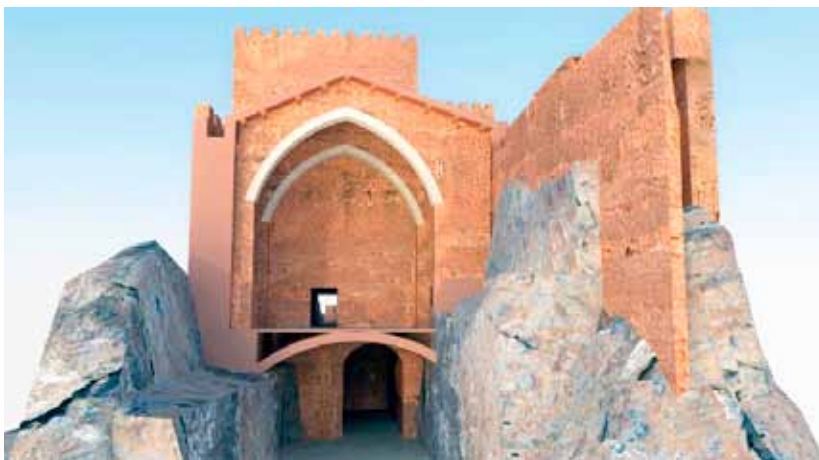
Figura 111. Castillo de D. Juan Manuel. Sección transversal del edificio construido con arcos diafragmáticos.
