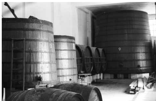
Figura 22: Antigua sala de crianza de vino en madera de Bodega Piqueras (Fotografía: José Ramón Martínez). En la imagen se observa el uso de conos (en posición vertical) y pipas (en posición horizontal) para envejecer los caldos de esta bodega fundada en 1915. El uso de madera para la cría de vinos se utiliza en Almansa desde finales del siglo XIX, algo que reflejan las fuentes con la creación de una fábricas de pipas y la llegada de maestros toneleros de las comarcas de La Mancha y el Vinalopó).
