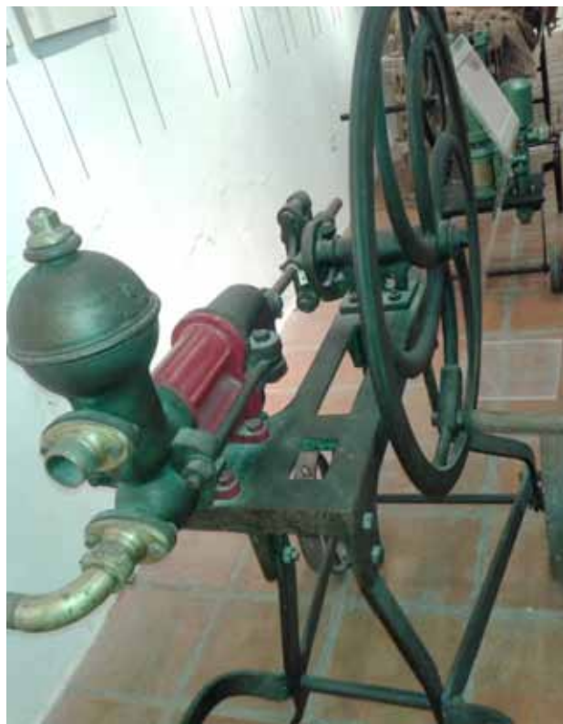
Figura 21: Bomba de trasiego de la exposición del Museo del Vino de Valdepeñas. El uso de bombas permitió transportar grandes volúmenes de vino lo que hacía posible implantar las nuevas técnicas de producción industrial (Fotografía: José Ramón Martínez).
